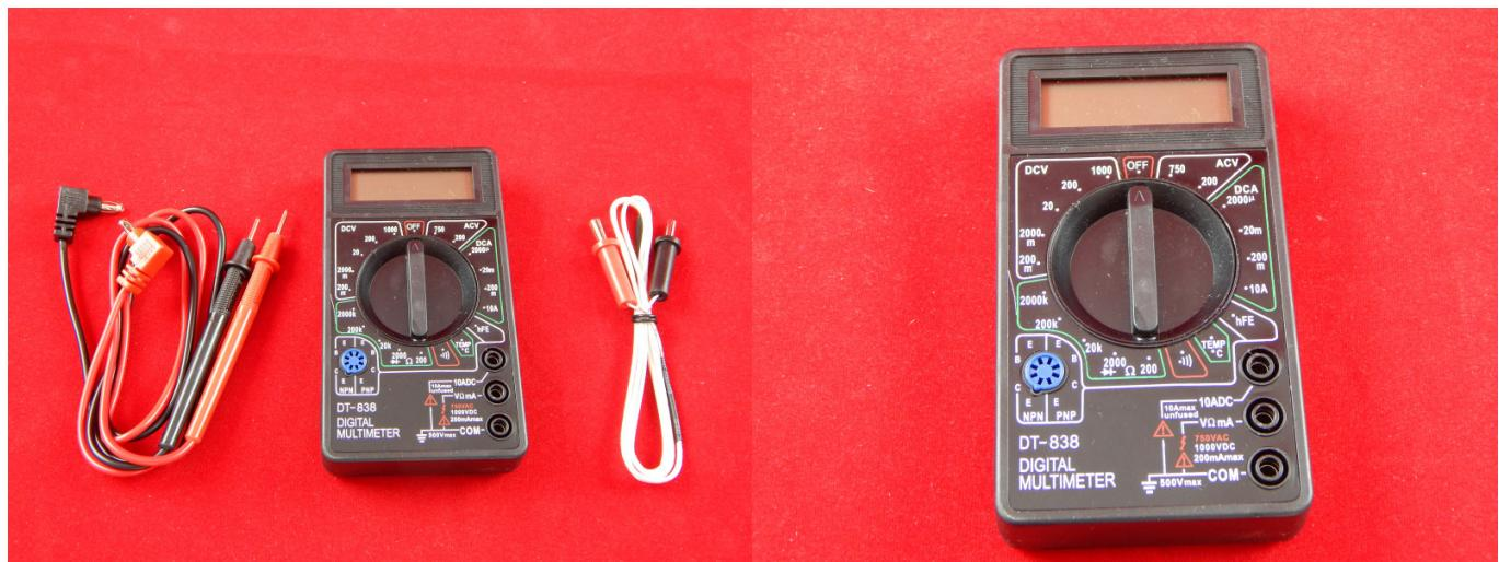
Мультиметр DT-838 в первую очередь предназначается для проведения замеров напряжения тока и его сопротивления, также DT-838 способен провести проверку диодов, транзисторов, звуковой прозвонки и температуры.
