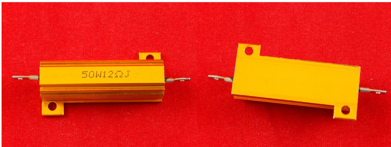
Резисторы широко применяются в цепях постоянного и переменного тока, обеспечивая ограничение силы тока и распределение напряжения, в мощных источниках питания, железнодорожном транспорте, тяговых промышленных устройствах, используются как тормозные резисторы.
