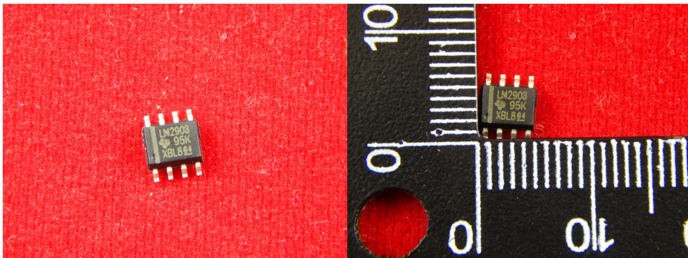
Компаратор - логический электронный прибор с двумя входами и одним выходом. Компаратор выдает высокое напряжение в случае, если напряжение на первом входе выше, чем на втором и низкое выходное напряжение если напряжение первого входа ниже вольтажа второго.
