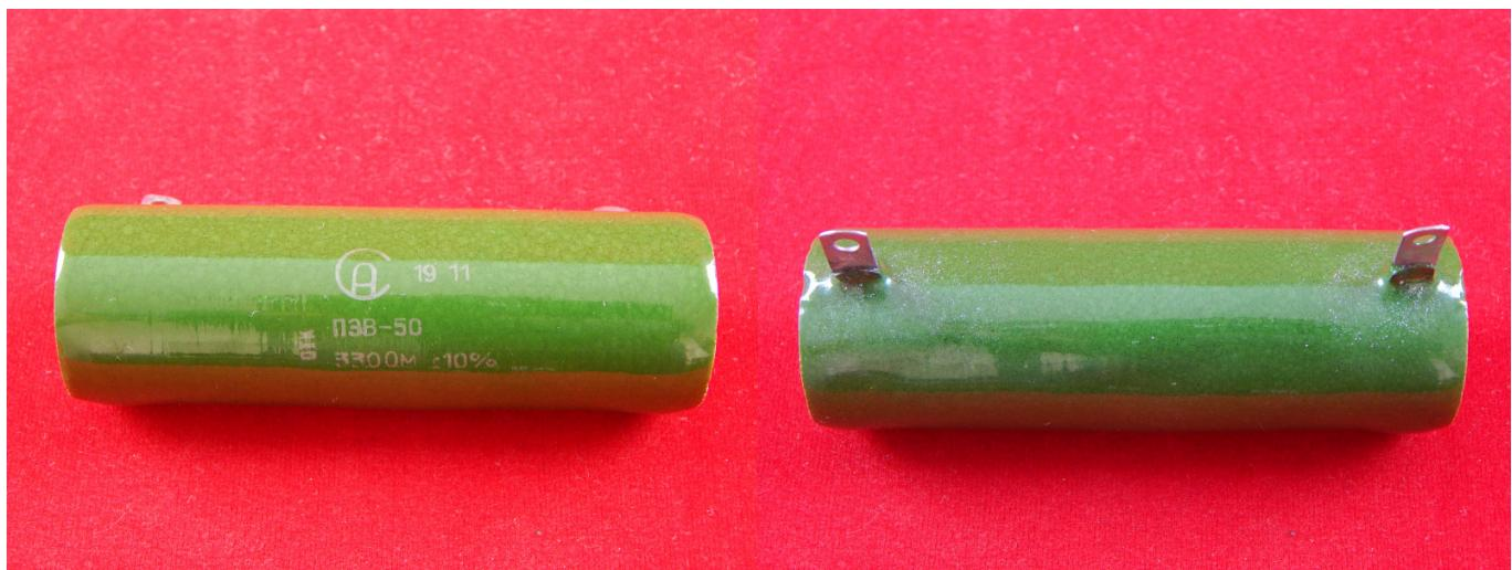
Резистор — пассивный элемент электрических цепей, обладающий определённым или переменным значением электрического сопротивления, предназначенный для линейного преобразования силы тока в напряжение и напряжения в силу тока, ограничения тока, поглощения электрической энергии и другое.
