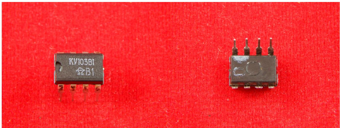
Тиристор — полупроводниковый прибор, выполненный на основе монокристалла полупроводника с тремя или более р-п-переходами и имеющий два устойчивых состояния: закрытое состояние — состояние низкой проводимости, открытое состояние — состояние высокой проводимости.
