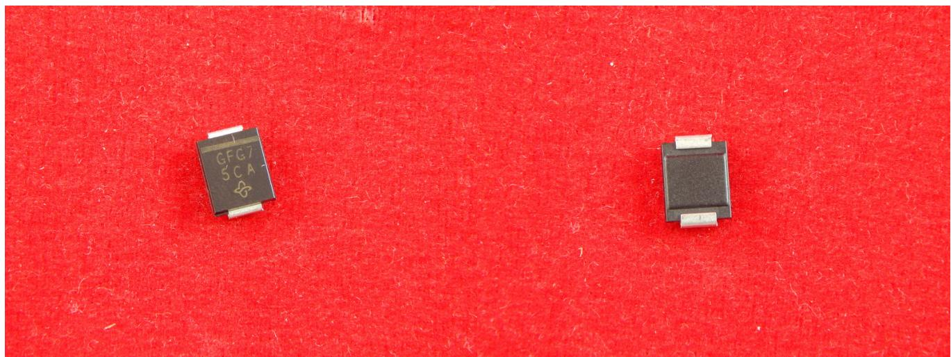
SM15T33A Защитный диод - TVS 1.5КВт 28.2В
