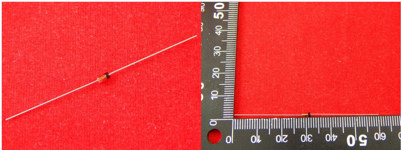
Стабилитроны – это полупроводниковые диоды, работающие при обратном смещении в режиме пробоя. До наступления пробоя через диод протекают малые токи, при наступлении пробоя ток, протекающий через стабилитрон, увеличивается и его сопротивление падает до определенного уровня.
