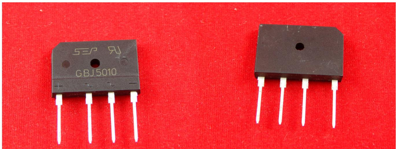
Диодный мост — электрическое устройство, предназначенное для преобразования («выпрямления») переменного тока в пульсирующий (постоянный). Такое выпрямление называется двухполупериодным. Данный диодный мост не имеет металлическую подложку для отвода тепла.
