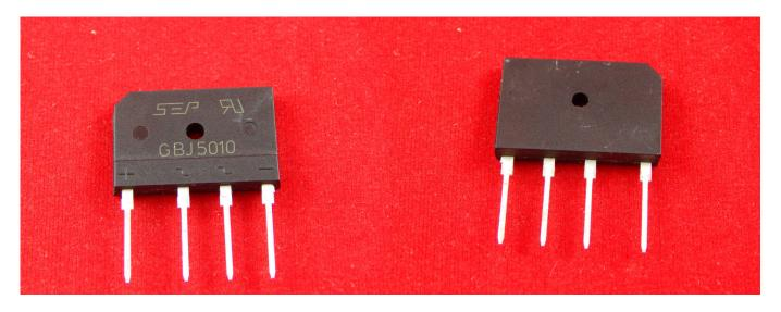
Диодный мост — электрическое устройство, предназначенное для преобразования («выпрямления») переменного тока в пульсирующий (постоянный). Такое выпрямление называется двухполупериодным. Данный диодный мост не имеет металлическую подложку для отвода тепла.
