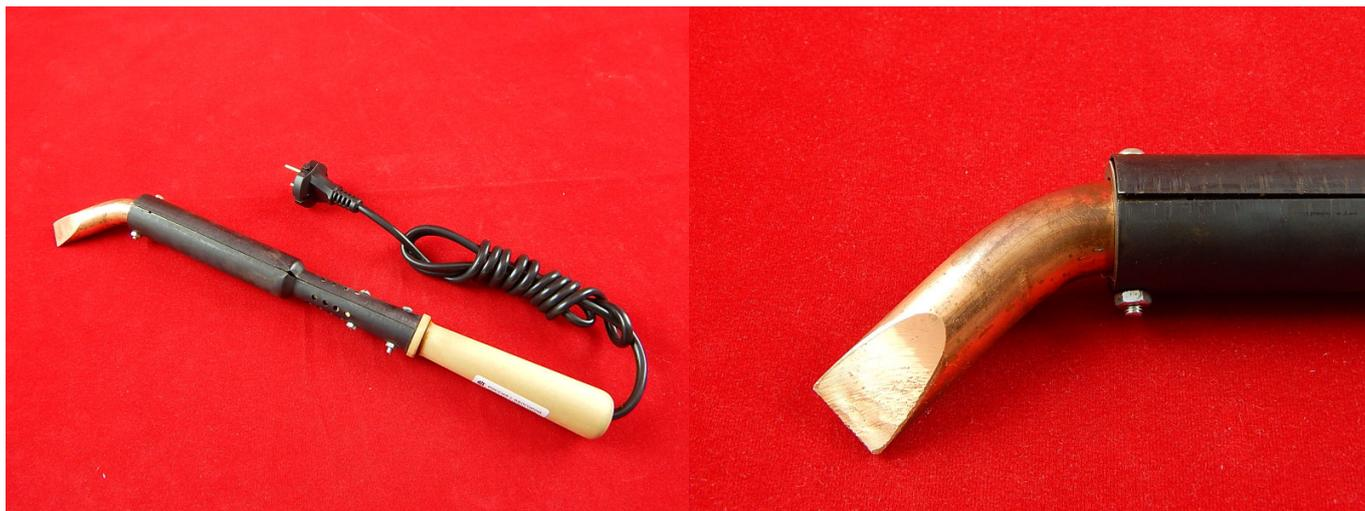
Классический мощный паяльник марки ЭПСН с круглым стержнем диаметром 20 мм. Предназначены для лужения и пайки массивных деталей при ремонте различных видов техники (радиаторы автомобилей, тракторов и тому подобное). Рабочее напряжение - 36В, 42В или 220 В.
