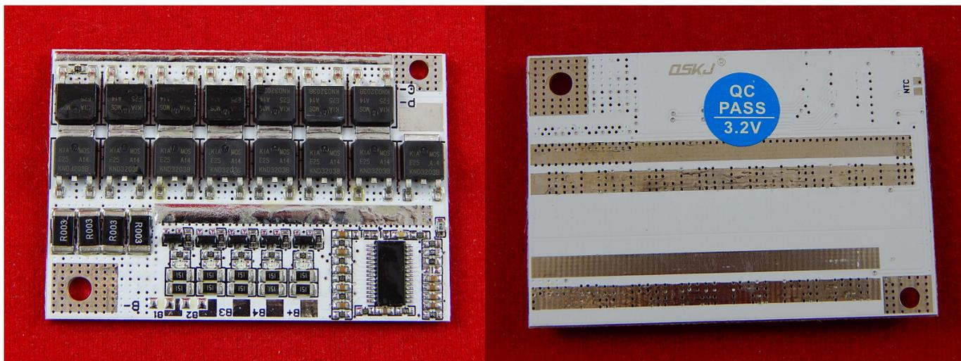
Контроллер заряда аккумулятора — электронная схема в составе зарядного устройства, предназначенная для управления процессом заряда аккумулятора.
