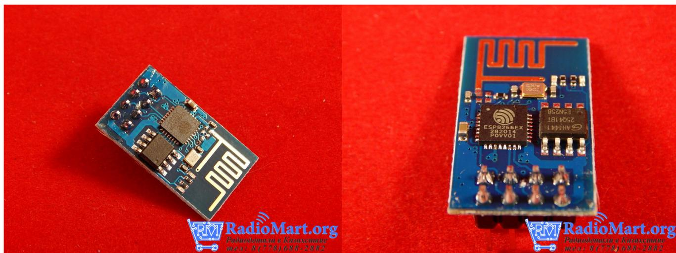
ESP8266 ESP-01 - это недорогой модуль для подключения различных устройств к сети через Wi-Fi.
