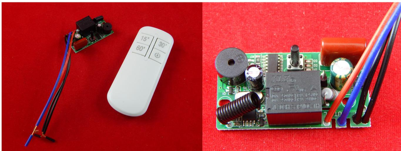
Реле времени, или таймер, отслеживает заранее заданное время и обеспечивает выполнение определенной функции по его истечению.
