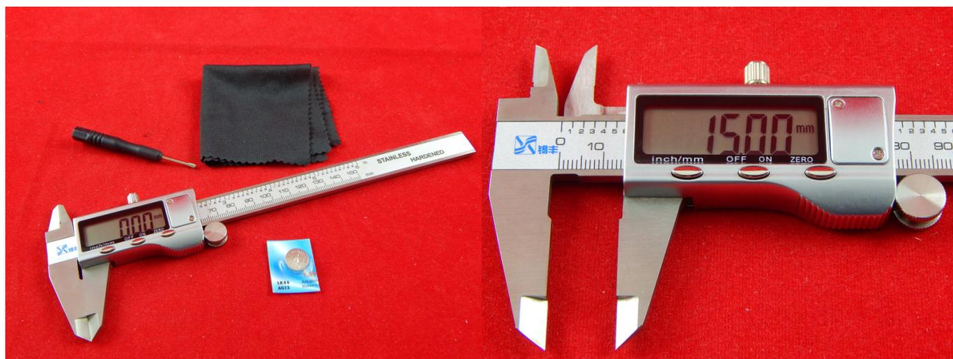
Штангенциркуль — это универсальный измерительный инструмент, который предназначен для высокоточного измерения наружных и внутренних линейных размеров, а в некоторых случаях - глубин отверстий.
