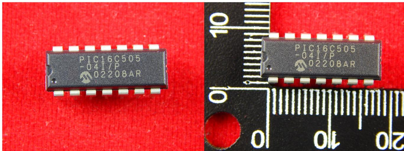
Микроконтроллер — микросхема, предназначенная для управления электронными устройствами. Типичный микроконтроллер сочетает на одном кристалле функции процессора и периферийных устройств, содержит ОЗУ и ПЗУ.
