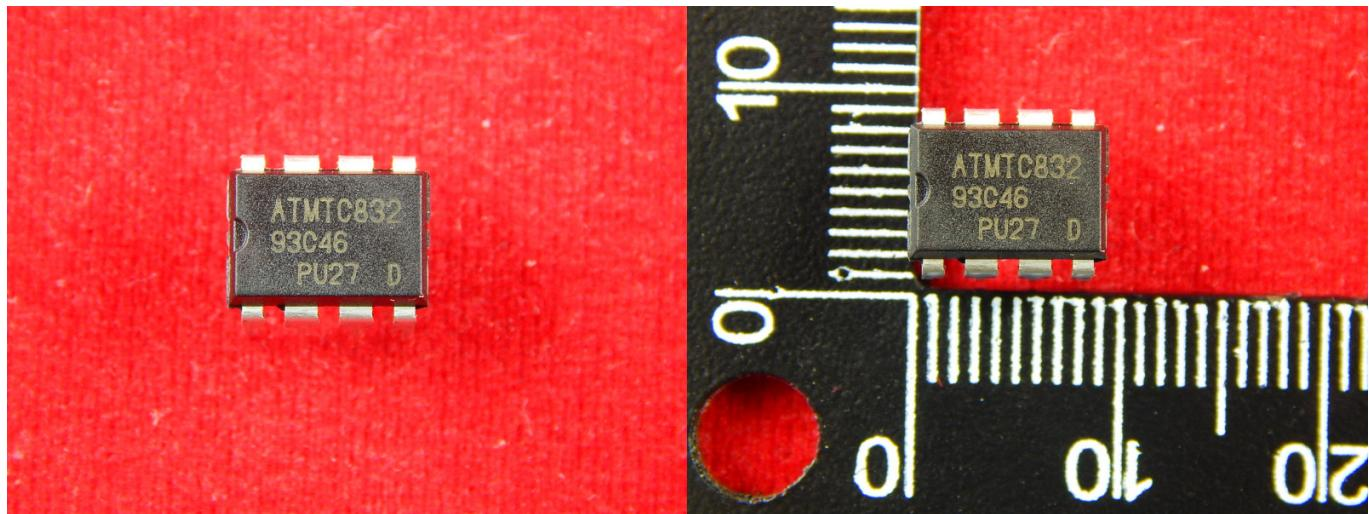
Микросхема AT93C46- энергонезависимая ППЗУ с возможностью перепрограммирования (EEPROM). В отличие от серии 24CXX может осуществлять запись не только в 6-ми битном коде, но и в 16-ти битном. Объем памяти микросхемы : 128 слов в 8-битном коде, или 64 в 16-ти битном.
