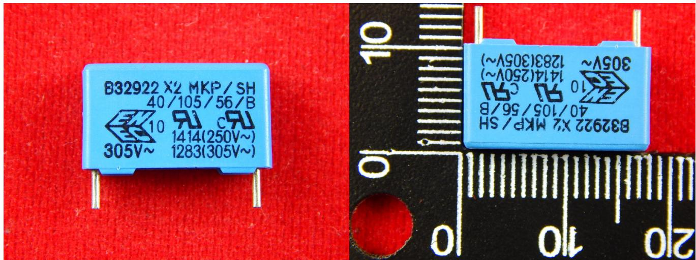
Конденсаторы подавления ЭМП – устройства, способные накапливать электрический заряд, которые используются для подавления электромагнитных помех. Из-за перенапряжения или переходных процессов, возникающих в цепи, могут произойти повреждения электронных компонентов. Для предотвращения таких неисправностей и используются конденсаторы.
