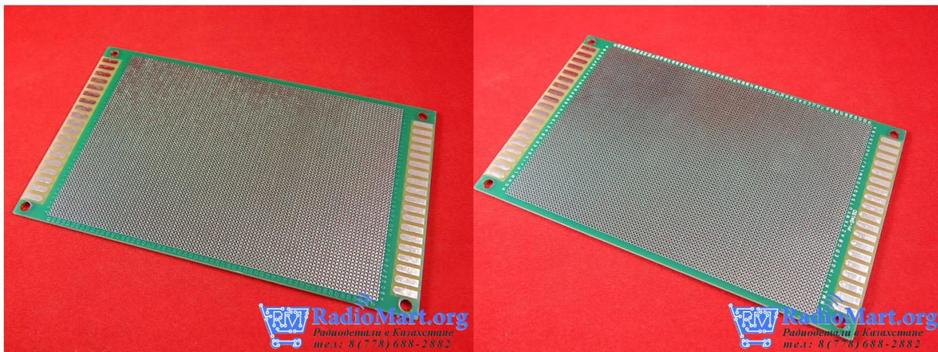
Двухсторонняя монтажная плата с расстоянием между отверстиями 1.27 мм
