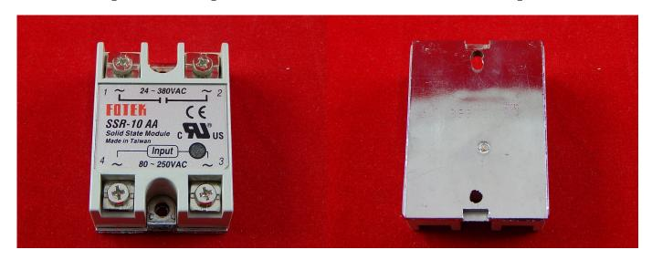
Твердотельные, или полупроводниковые реле, предназначены для бесконтактной коммутации нагревательных элементов, ламп, сварочных агрегатов и других устройств. В данном случае рабочее напряжение которого идет от 24 до 380 В переменного или постоянного тока и может управляться постоянным или переменным напряжением.
