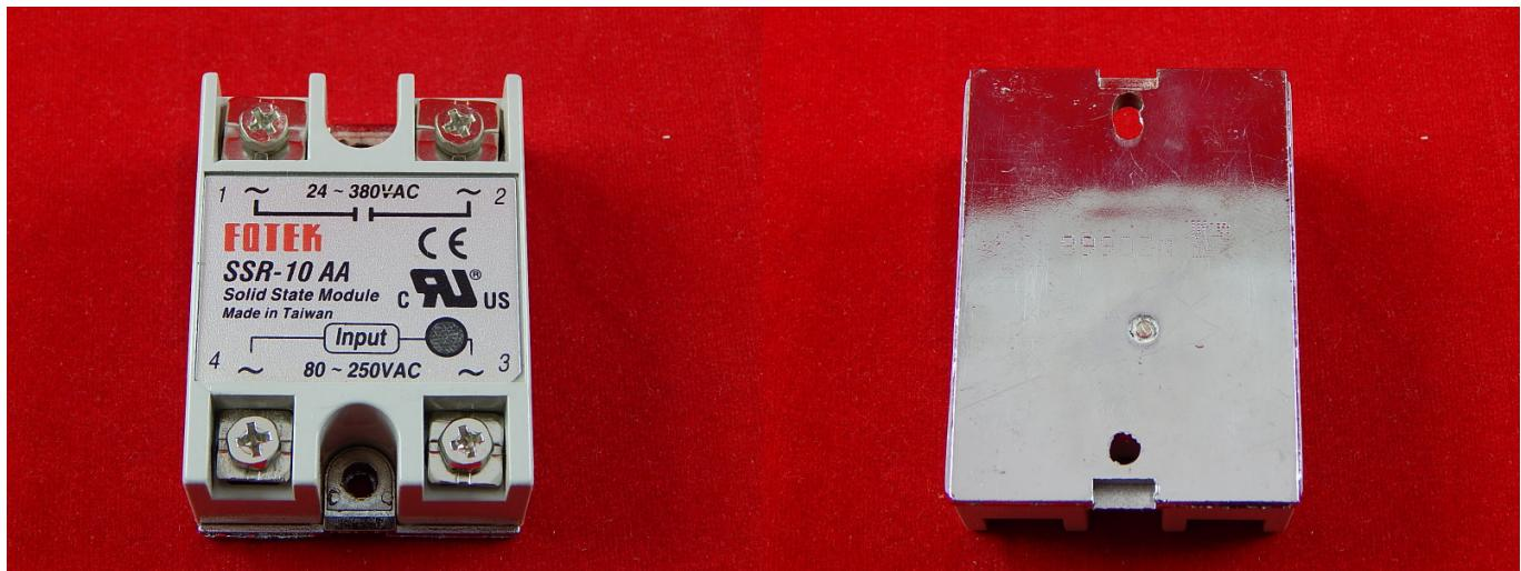
Твердотельные, или полупроводниковые реле, предназначены для бесконтактной коммутации нагревательных элементов, ламп, сварочных агрегатов и других устройств. В данном случае рабочее напряжение которого идет от 24 до 380 В переменного или постоянного тока и может управляться постоянным или переменным напряжением.
