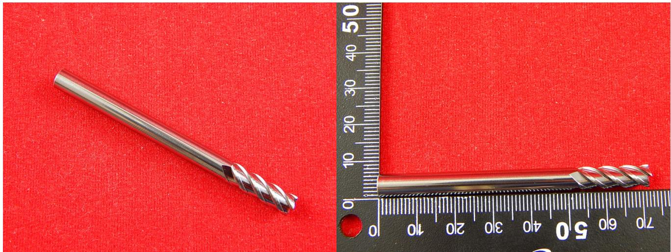
Фреза — инструмент с одним или несколькими режущими лезвиями для фрезерования.
