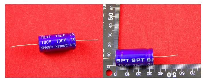
Конденсатор - двухполюсник с постоянным или переменным значением ёмкости и малой проводимостью, устройство для накопления заряда и энергии электрического поля. Конденсатор является пассивным электронным компонентом. Ёмкость конденсатора измеряется в фарадах, данный конденсатор имеет 75uF.
