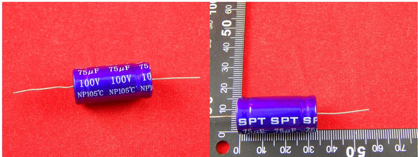
Конденсатор - двухполюсник с постоянным или переменным значением ёмкости и малой проводимостью, устройство для накопления заряда и энергии электрического поля. Конденсатор является пассивным электронным компонентом. Ёмкость конденсатора измеряется в фарадах, данный конденсатор имеет 75uF.
