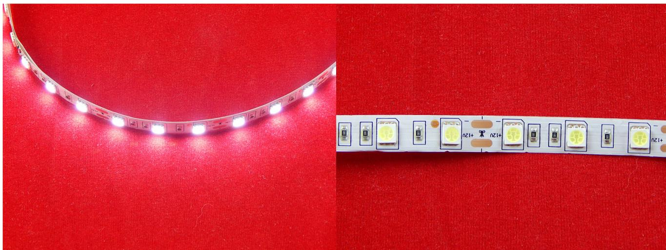
Преимуществом светодиодной ленты на основе SMD 5050 является высокая яркость. Светодиодная лента, основанная на светодиодах типа SMD 5050 и выполнена на основе гибкой самоклеящейся печатной платы с прочным клеевым слоем. В светодиодах SMD 5050 включено в своём составе три независимо излучающих кристалла.
