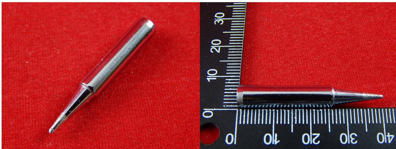
Рабочая часть паяльника называемая жалом. Данное жало является сменным и процесс его установки достаточно прост. Для этого нужно просто выключить паяльник, вытянуть установленное жало и вставить в ручку другое. Далее можно включать паяльник и через очень небольшой промежуток времени продолжать работу.
