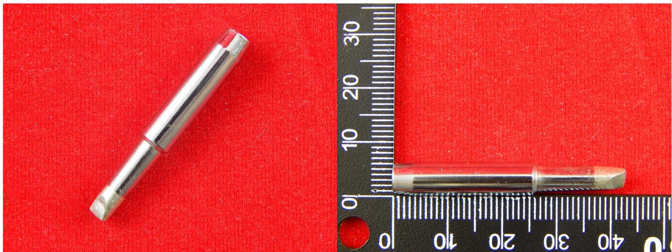
Рабочая часть паяльника называемая жалом. Данное жало является сменным и процесс его установки достаточно прост. Для этого нужно просто выключить паяльник, вытянуть установленное жало и вставить в ручку другое. Дальше можно включать паяльник и через очень небольшой промежуток времени продолжать работу.
