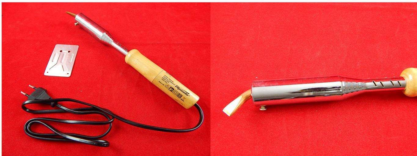
Существует много различных способов скрепления различных деталей между собой для получения готового изделия. Пайка занимает почётное второе место по применяемости после сварки. А есть такие сферы производства, где пайка вообще незаменима. Например электроника. Трудно представить себе телевизор, где крепление микросхем к плате производилось бы болтами. И поэтому для пайки используются паяльники.
