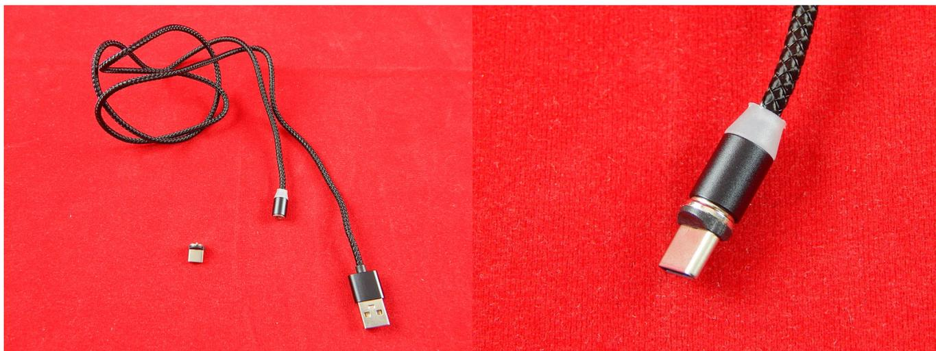
Магнитный кабель правильнее называть кабелем с подключаемым разъемом. Основная часть состоит из обычного провода, разъема USB для подключения к зарядному устройству, и контактной площадки с мощным магнитом. К ней подсоединяется зарядная часть в составе разъема, магнита и контактов.
