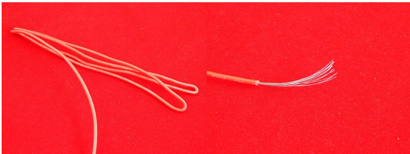
AWG — Американская система калибров проводов (American Wire Gauge System). Зависимость AWG от толщины, мм - чем меньше калибр AWG, тем толще провод.
