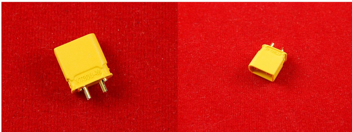
XT30 - это один из самых надёжных и часто используемых разъёмов питания в пластиковом корпусе, которые применяются на аккумуляторных батареях и зарядных устройствах, предназначенных для использования в коптерах и других радиоуправляемых моделях. Встречается в ранних коптерах компании DJI.
