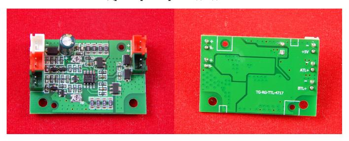
Драйвер лазерного диода – это схема, которая используется для ограничения тока и затем подачи его на лазерный диод, чтобы он работал должным образом. Если мы напрямую подключим его к источнику питания, из-за потребности в большем токе он может не заработать или даже привести к некоторым повреждениям цепи.
