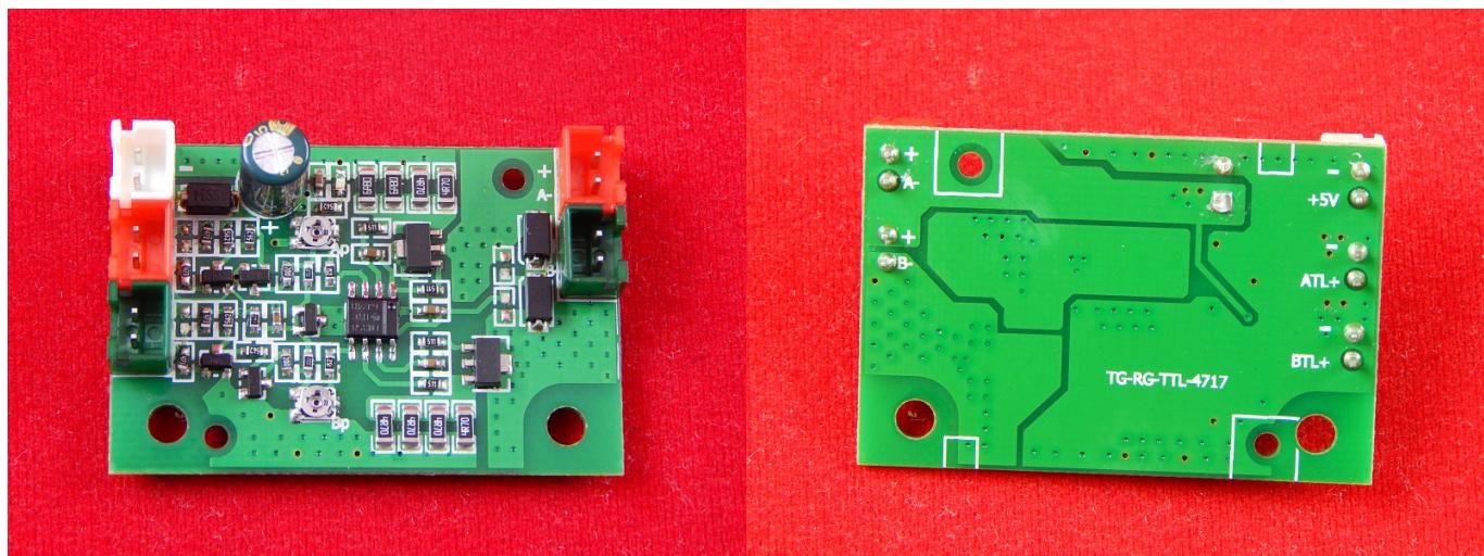
Драйвер лазерного диода – это схема, которая используется для ограничения тока и затем подачи его на лазерный диод, чтобы он работал должным образом. Если мы напрямую подключим его к источнику питания, из-за потребности в большем токе он может не заработать или даже привести к некоторым повреждениям цепи.
