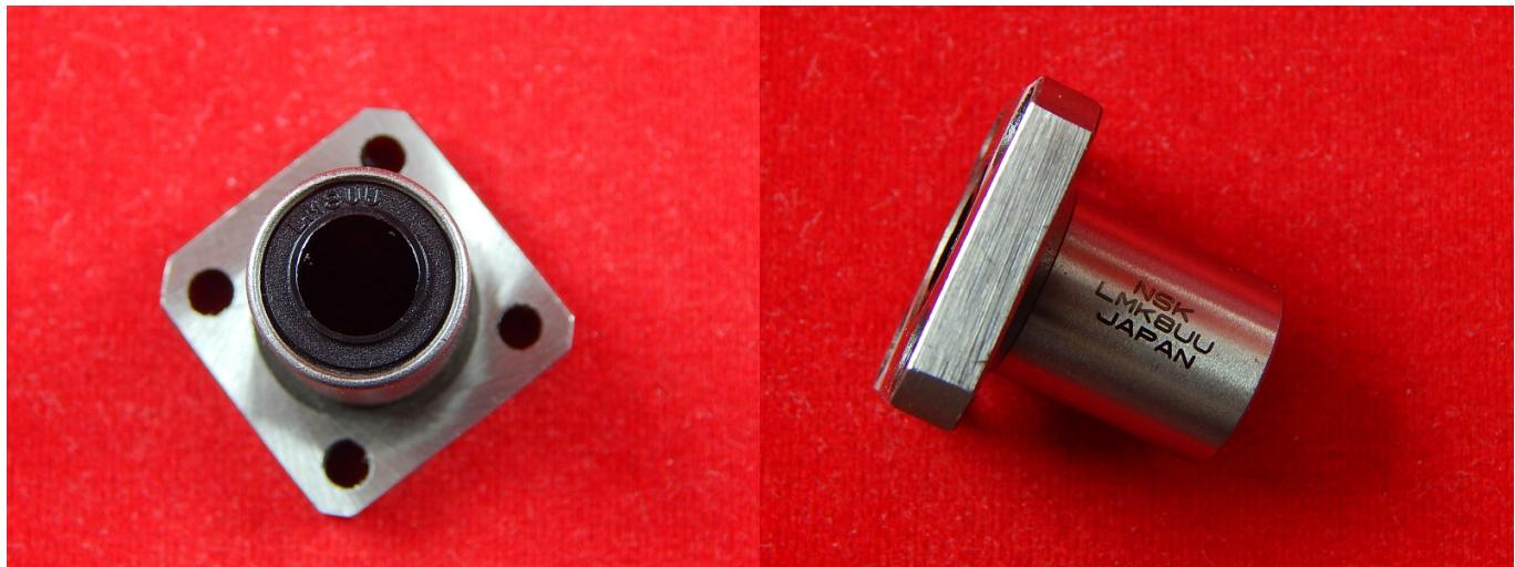
Фланцевый линейный подшипник серии LMK обеспечивает удобное крепление к корпусной детали с помощью монтажного фланца. Для установки или замены фланцевой втулки не требуются специальные инструменты, кроме отвертки или шестигранного ключа. Стальной корпус подшипника и пластиковый сепаратор обеспечивают долговечную и надежную работу.
