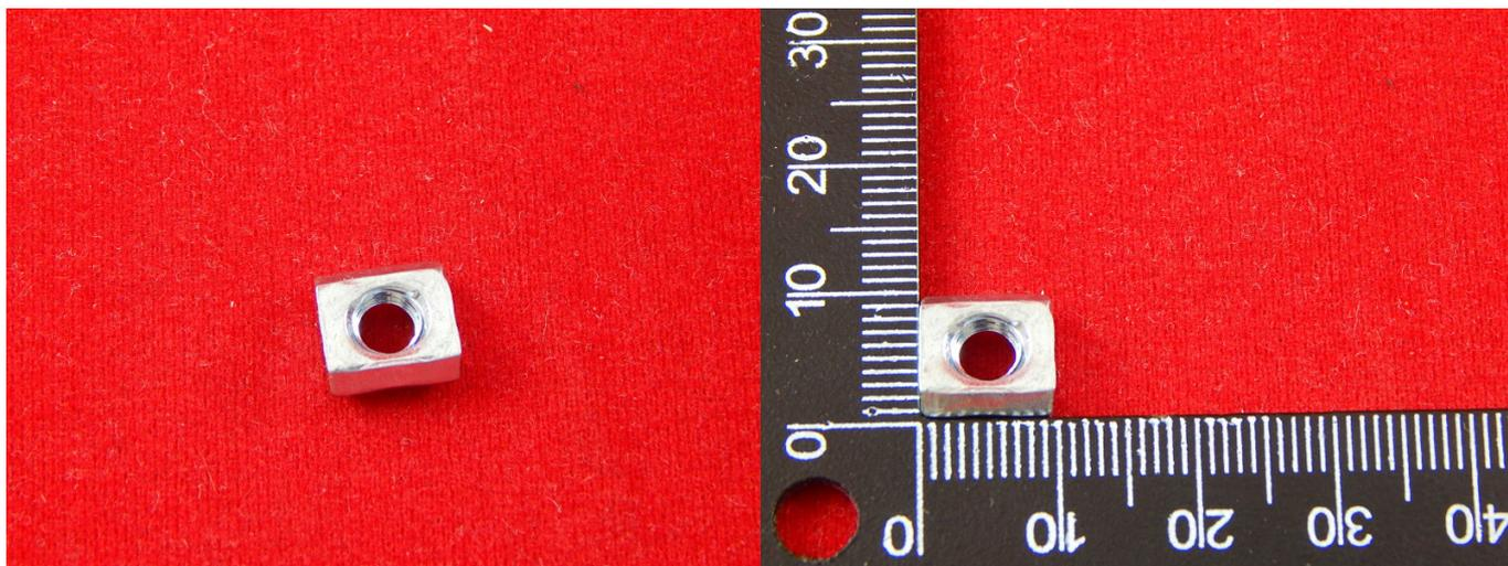
Сухарь пазовый вводится в паз с торца профиля и позволяет крепить к профилю различные дополнительные элементы и конструкции, используя болты и винты с соответствующей резьбой.
