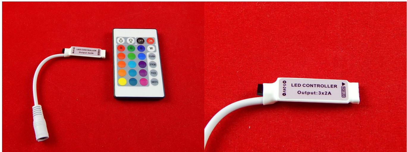
Контроллер может управлять яркостью, режимами мигания, чередования цветов, цветом свечения, путем смешивания базовых цветов светодиодной RGB-ленты возможно создать любые цвета и оттенки.
