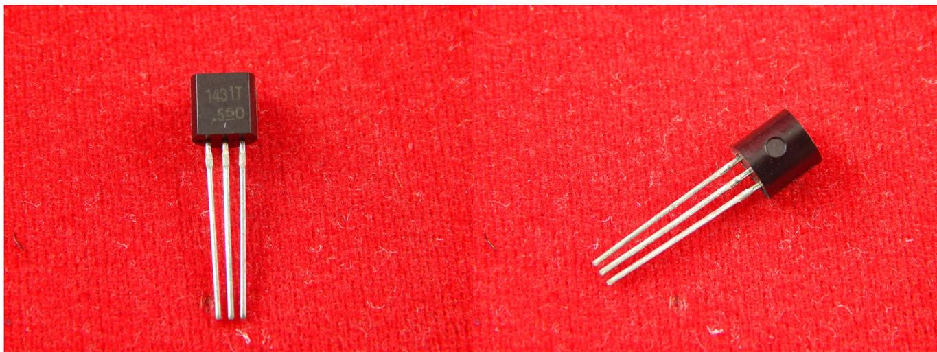
Линейный стабилизатор напряжения AN1431T, корпус TO-92.
