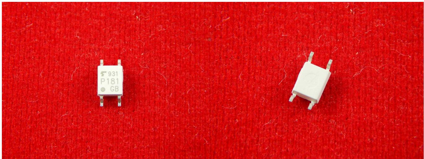
Оптопара - наиболее простая разновидность оптрана. Она состоит только из излучающей и принимающей частей.
