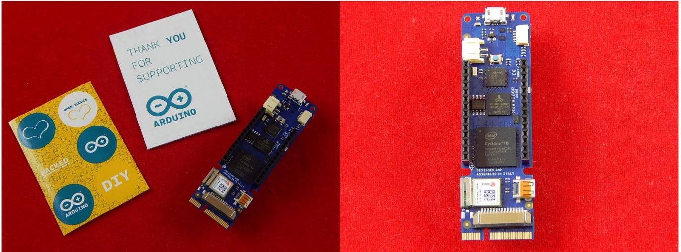
Arduino MKR Vidor 4000 — это первая плата семейства Arduino на базе программируемой логической интегральной схемы (она же ПЛИС, она же FPGA).
