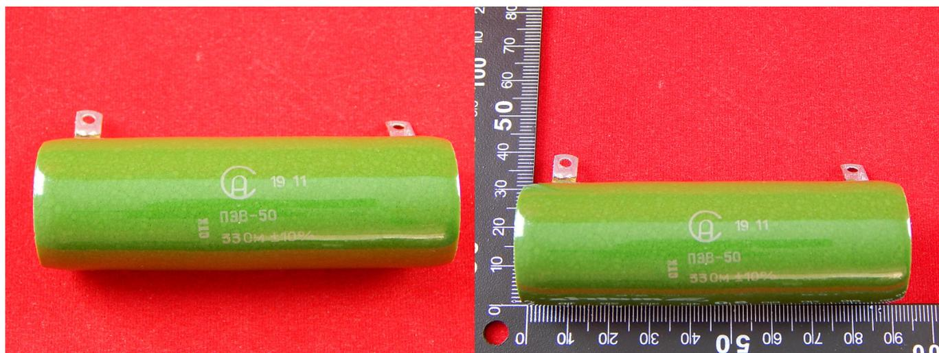
Резисторы ПЭВ – постоянные проволочные (П) эмалированные (Э) влагостойкие (В) трубчатые резисторы, номинальное сопротивление от 1 Ом до 100 кОм рассеиваемая мощность в зависимости от номинала – от 3Вт до 160Вт. Предназначены для эксплуатации в цепях постоянного и переменного тока, обеспечивая ограничение силы тока и распределение напряжения.
