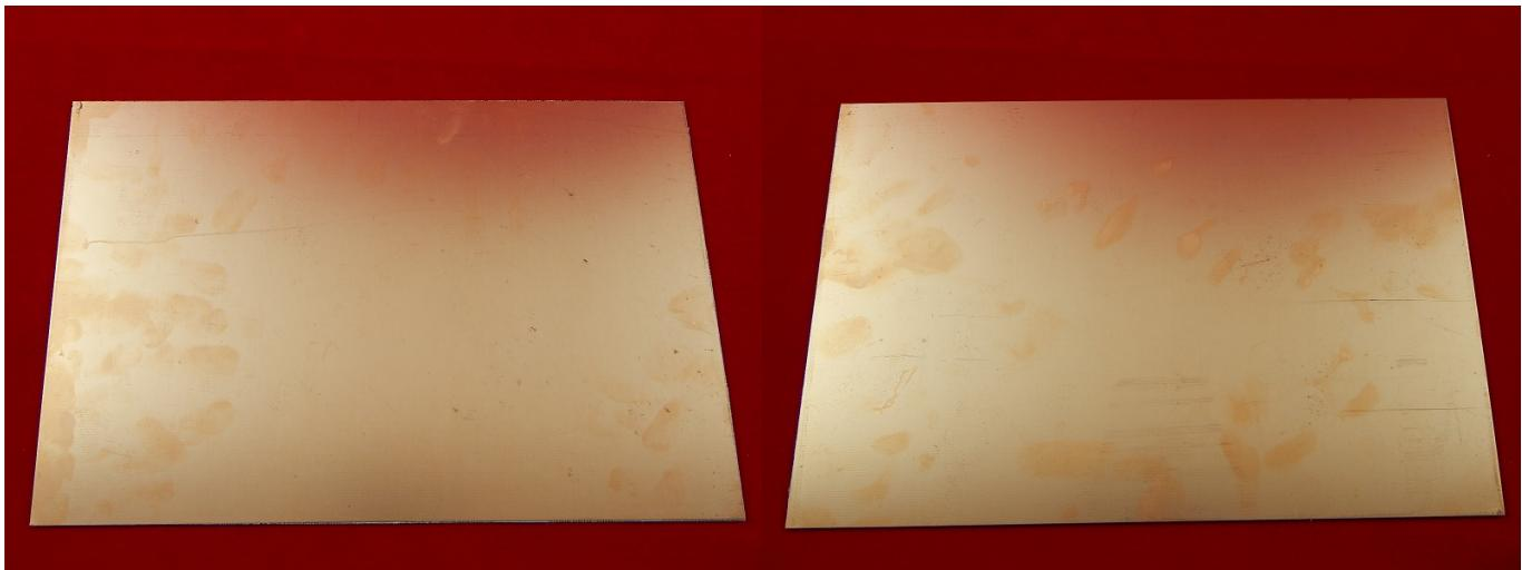
Печатная плата двухсторонняя 20x30см (Стеклотекстолит FR-4 1,5мм) предназначена для электрического и механического соединения различных электронных компонентов. Электронные компоненты на печатной плате соединяются своими выводами с элементами проводящего рисунка обычно пайкой.
