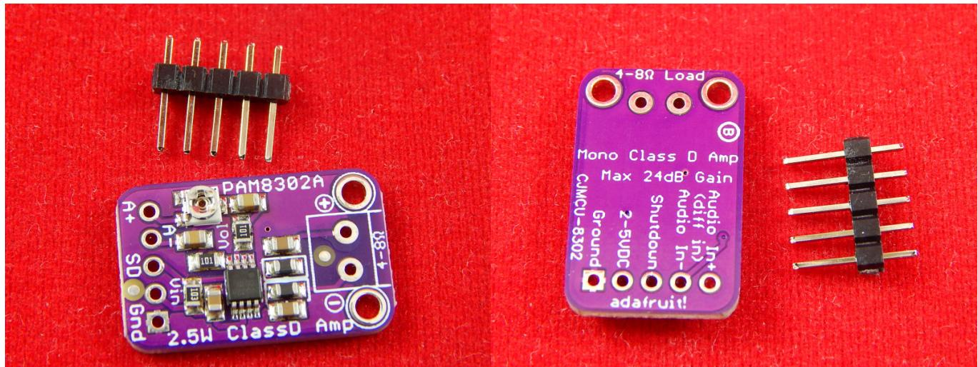
Моноусилители мощности, также известные как усилители-моноблоки, обеспечивают один канал на выходе (например, только левый, только правый или для одного из громкоговорителей системы окружающего звучания). То есть, в отличие от стереоусилителей, моноусилители – одноканальные.
