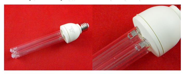
Кварцевая лампа — электрическая ртутная газоразрядная лампа с колбой из кварцевого стекла, предназначенная для получения ультрафиолетового излучения. В отличие от обычного стекла, кварцевое стекло пропускает ультрафиолет, что и позволяет ему обеспечивать обеззараживающий и терапевтический эффект использования таких ламп.
