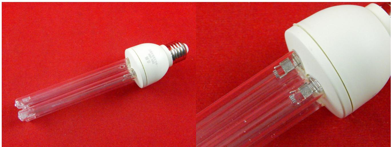
Кварцевая лампа — электрическая ртутная газоразрядная лампа с колбой из кварцевого стекла, предназначенная для получения ультрафиолетового излучения. В отличие от обычного стекла, кварцевое стекло пропускает ультрафиолет, что и позволяет ему обеспечивать обеззараживающий и терапевтический эффект использования таких ламп.
