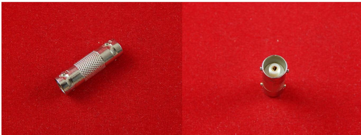
Коннектор BNC — электрический разъем с байонетной фиксацией. Служит для подключения коаксиального кабеля с волновым сопротивлением 50 Ом или 75 Ом и диаметром до 8 мм. Потери в таком разъёме обычно не превышают 0.3 дБ. Разъем изготовлен из никелированного цинка, центральный контакт из латуни с напылением технического золота.
