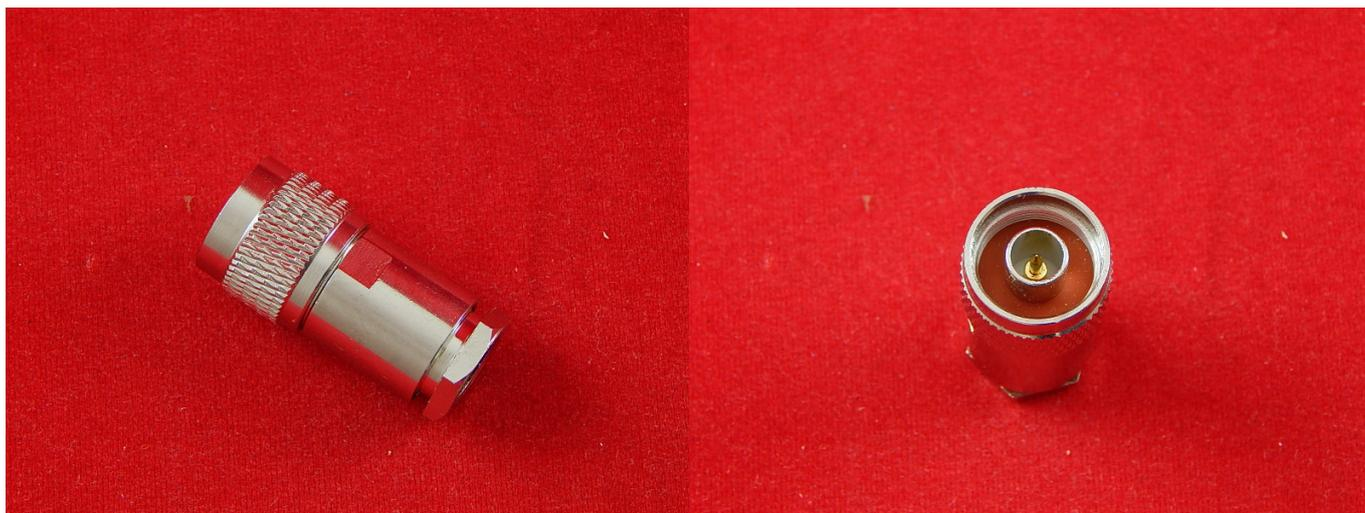
N разъем (N коннектор) — коаксиальный радиочастотный разъём для передачи сигналов на сверхвысоких частотах. Разъемы N типа бывают двух видов на 50 Ом и 75 Ом. В системах усиления сотовой связи и интернета используют N коннекторы для кабеля на 50 Ом. N разъемы на 75 Ом используются для кабельного телевидения.
