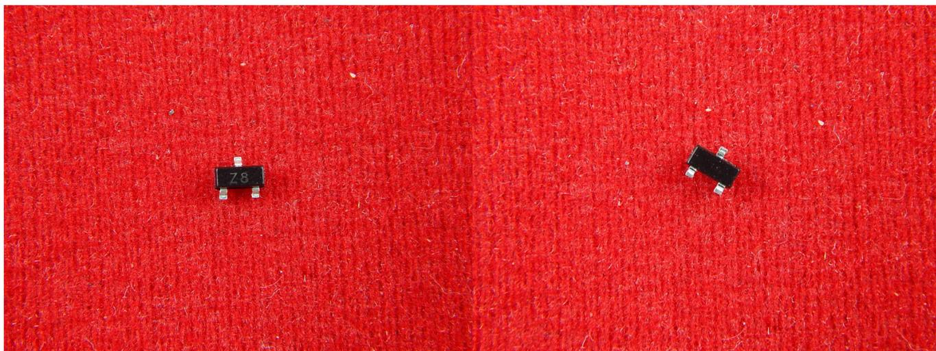
Полупроводниковый стабилитрон, или диод Зенера — полупроводниковый диод, работающий при обратном смещении в режиме пробоя. До наступления пробоя через стабилитрон протекают незначительные токи утечки, а его сопротивление весьма высоко.
