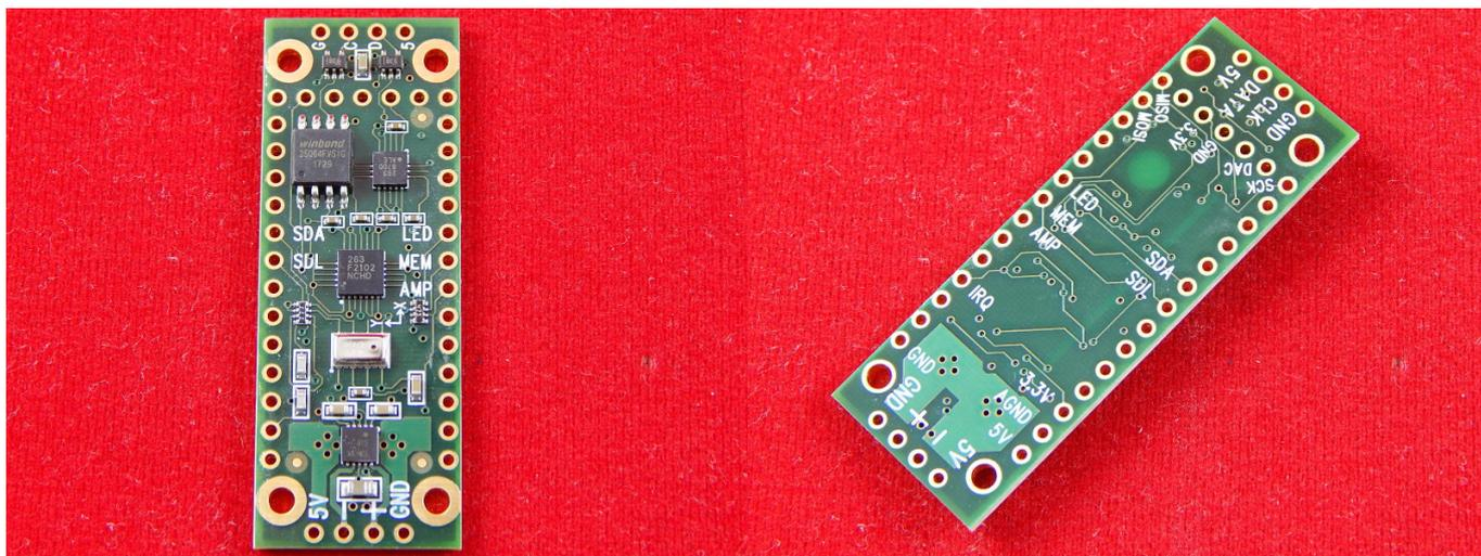
Teensy Prop Shield предназначен для создания интерактивных световых и звуковых эффектов на небольших портативных реквизитах и носимых костюмах.
