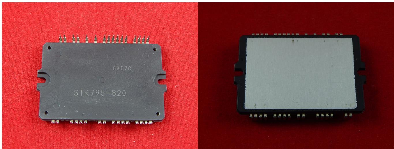
IGBT транзистор - трёхэлектродный силовой электронный прибор, используемый, в основном, как мощный электронный ключ в импульсных источниках питания, инверторах, в системах управления электрическими приводами.
