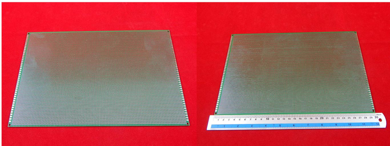
Двусторонняя печатная плата 20x30 см, металлизированные отверстия, дополнительные контактные площадки по краям, шаг 2.54 мм.
