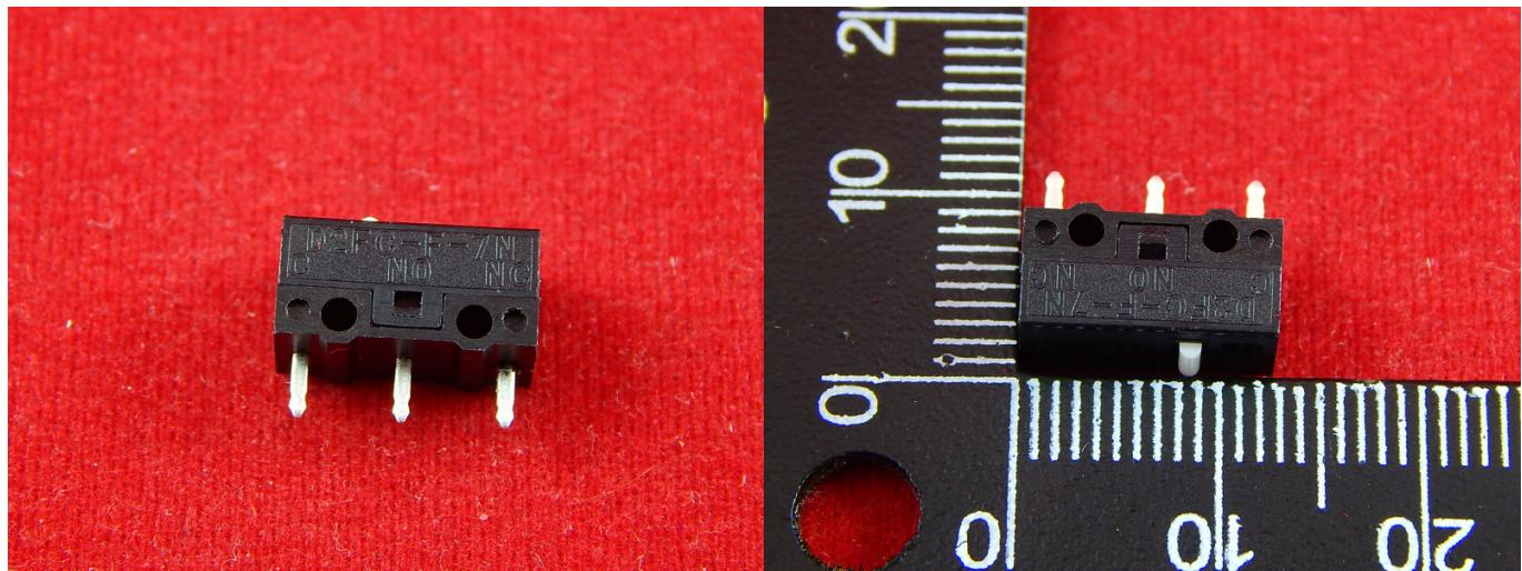
Микровыключатель D2FC-F-7N с ресурсом в пять миллионов нажатий. Имеет три контакта - общий, нормально замкнутый и нормально разомкнутый.
