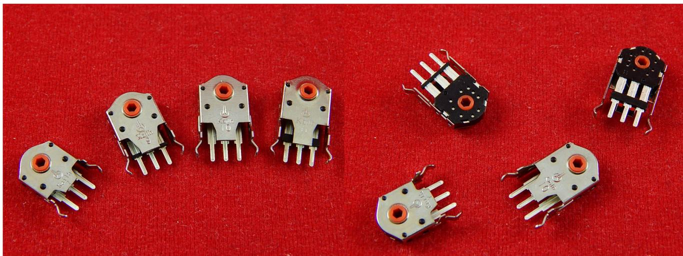
Энкодеры — устройства, предназначенные для преобразования угла поворота вращающегося объекта (вала) в электрические сигналы, позволяющие определить угол его поворота. Может использоваться в различных микроконтроллерных устройствах. Также энкодер Kailh подходит для замены изношенного энкодера во многих моделях компьютерных мышек.
