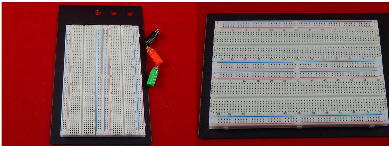
Беспаячная макетная плата представляет собой средство для изготовления прототипа электронного устройства без применения пайки.
