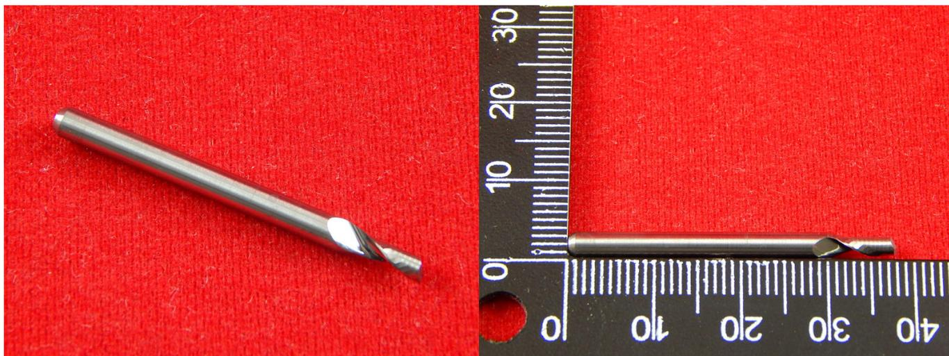
Однозаходная спиральная цилиндрическая твердосплавная фреза для чистого (мягкого) алюминия, но так же можно использовать на меди и других пластичных металлах, композитных панелях.
