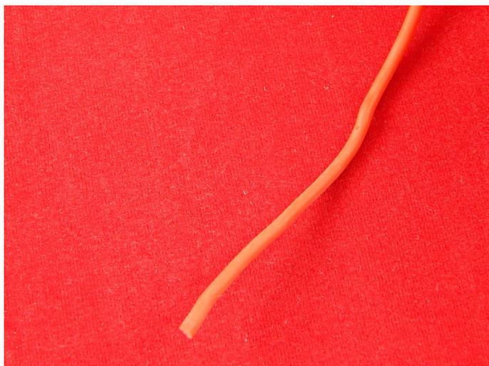
AWG — Американская система калибров проводов (American Wire Gauge System). Зависимость AWG от толщины, мм - чем меньше калибр AWG, тем толще провод.
