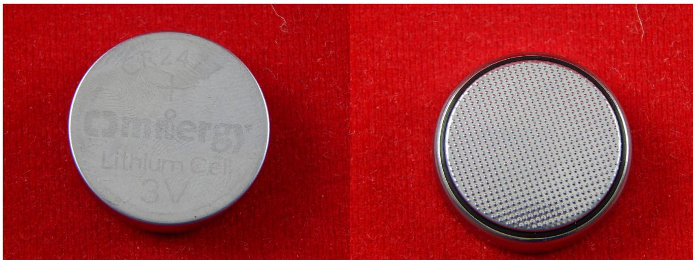
Неперезаряжаемый литий-диоксид марганцевый элемент питания типоразмера 2477. Номинальное напряжение 3В.
